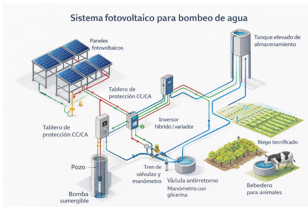
Figura 1. Esquema del sistema fotovoltaico híbrido para bombeo de agua
